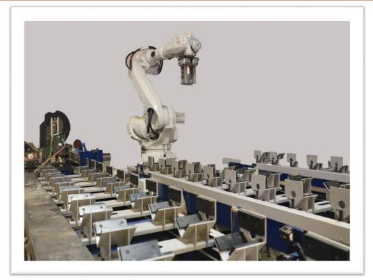
**ROBOTIC ARM BASED MULTIPLE CHANNEL IMMERSION ULTRASONIC TESTING SYSTEM**
